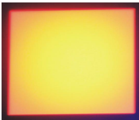
Obr. 9 – Demonštrácia aditívneho skladania farieb: oranžová vznikla zložením červenej a zelenej.
